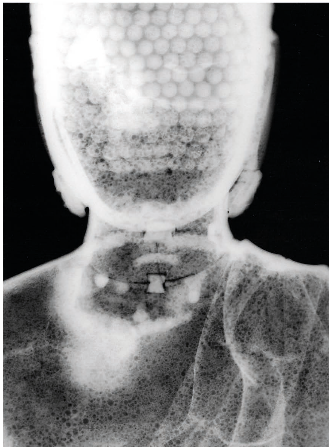
La radiographie montre que l'objet fut fondu en deux parties. Les tenons d'attache sont nettement visibles au niveau du cou.
